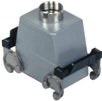
Custodia mobile, serie C-TYPE, con 2 leve, ingresso cavo verticale Pg21, grandezza "66.40", alta, senza guarnizione
