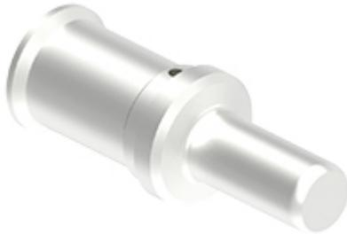
Contatto a crimpare maschio, serie C30, 300 A, tornito argentato, sezione conduttore 35 mm<sup>2</sup>, AWG 2
