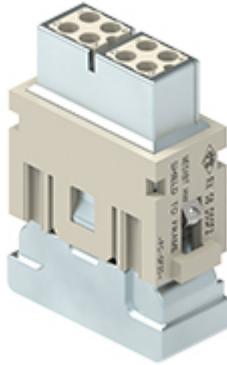
Buchseneinsatz, MIXO HNM, 1ME, 8P+GND, Crimpanschluss, 10A, 50V, Megabit, doppelte Kabeleinführung, mit PE Kontaktierung
