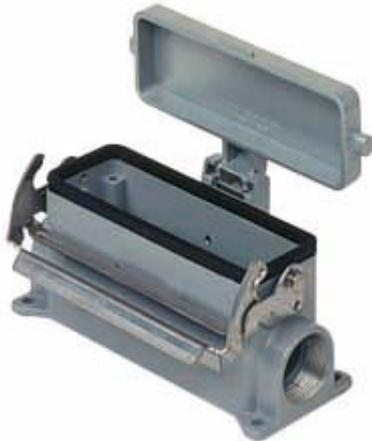
Sockelgehäuse, Gr.57.27, V-TYPE Alu, 1 Bügel, 1xM20 seitlich, Deckel Metall
