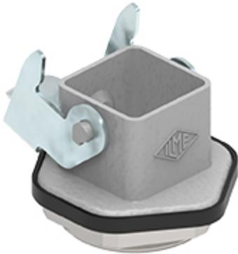
Einschraubgehäuse, Gr.21.21, Alu, 1 starrer Bügel Stahl, 1xM32 außen, Profildichtung
