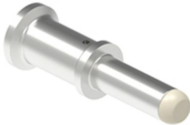
Stiftkontakt, 16mm<sup>2</sup>, Silber, Crimpanschluss, 70A, Baureihe CX7, extra flexibler Leiter der Klasse 6, fingersichere Ausführung
