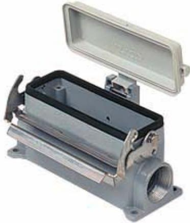
Sockelgehäuse, Gr.57.27, V-TYPE Alu, 1 Bügel, 2xPg 16 seitlich, Deckel Kunststoff
