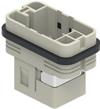
Stifteinsatz, Gr.32.13, 8P+PE, Crimpanschluss, 16A, 500V, zusätzl. PE-Gehäusekontaktier.
