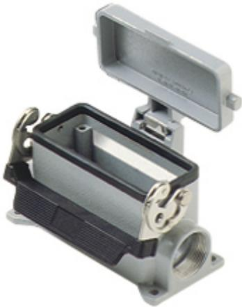
Sockelgehäuse, Gr.77.27, 830V Alu, 1 Bügel, 2xPg 21 seitlich, Deckel Metall
