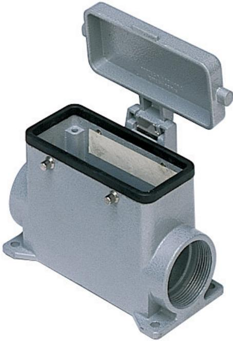
Sockelgehäuse, hoch, Gr.77.27, 830V Alu, 4 Bolzen, 2xPg 29 seitlich, Deckel Metall
