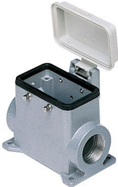
Sockelgehäuse, hoch, Gr.57.27, 830V Alu, 4 Bolzen, 2xPg 21 seitlich, Deckel Kunststoff
