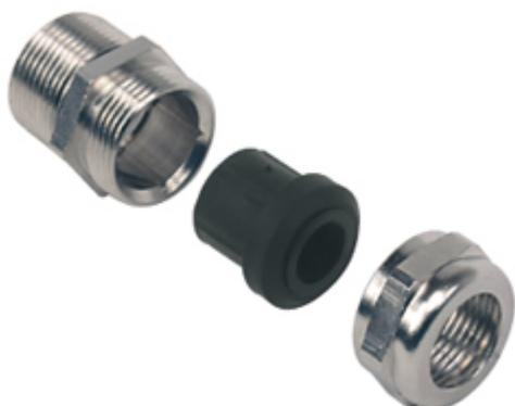
Komplettverschraubung, M25, Messing vernickelt, Klemmbereich 10-18mm, lang
