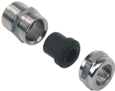
Komplettverschraubung, Pg 29, Messing vernickelt, Klemmbereich 14-24mm, lang
