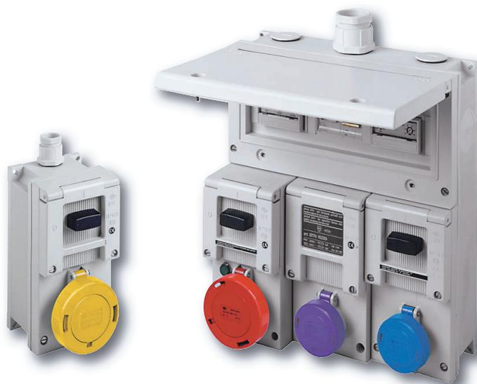
Nelle prese BK è stato introdotto il nuovo interruttore combinato con portafusibili che permette la manovra di inserimento ed estrazione delle **cartucce fusibili** in modo comodo, veloce e sicuro.
