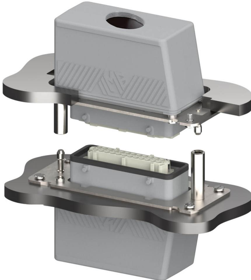
Beim **automatischen Werkzeugwechsel** müssen elektrische Steckverbinder nicht nur selbstzentrierend zusammenfinden, auch der IP-Schutz ist wichtig für eine **einwandfreie Funktion** und Langlebigkeit. Steckverbindergehäuse der Serie **BIG** mit **Edelstahl Andockrahmen MBV...D** ermöglichen einen IP-geschützten, automatischen Steckvorgang für die **Einschubtechnik** von Racks, dem **Formen- und Werkzeugbau** für Spritzgussmaschinen und dem Aufbau von modularen Maschinen im Inline Design.
