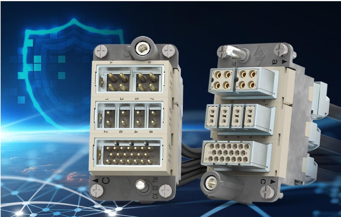
Schnittstellen, die Datenstandards wie **PROFINET** mit Gigabit oder Megabit **Industrial Ethernet** übertragen, benötigen einen besonders hohen **EMV-Schutz** und die bestmögliche **360°** Abschirmung. Um hier den höchsten Schutz zu erreichen, wird je nach Anwendungsgebiet (z. B. **Railway**) die **Schirmübertragung** getrennt oder so oft wie möglich verbunden zum **Schutzleiter** (PE) ausgeführt. Mit den Shielded **MIXO Modulen** von **ILME** ist dies immer wahlweise möglich:
