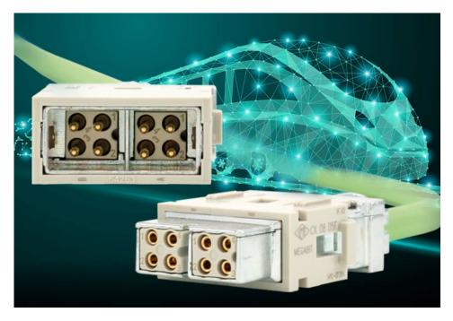
Ein individuelles IIoT- oder Datenbus-Netzwerk kann mit dem neuen MIXO Megabit Modul CX 08 D5 aufgebaut werden. Durch die spezielle Kontur lässt sich entweder eine 8polige Ethernetleitung mit 4 STP oder zwei separate 4polige Leitungen mit jeweils 2 STP und eigener Schirmanbindung in einem modularen Steckverbinder integrieren.
