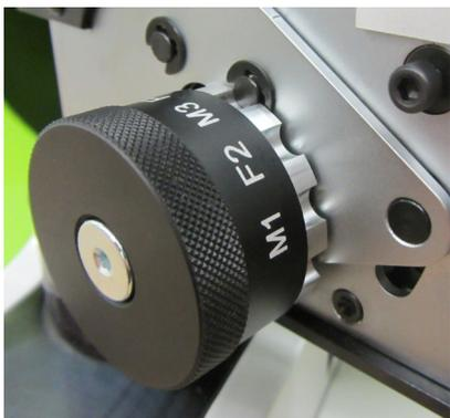
Positioniereinheit mit 6 individuellen Stellungen (M1 bis F6) für die perfekte Position der Crimpung auf dem Kontakt.
