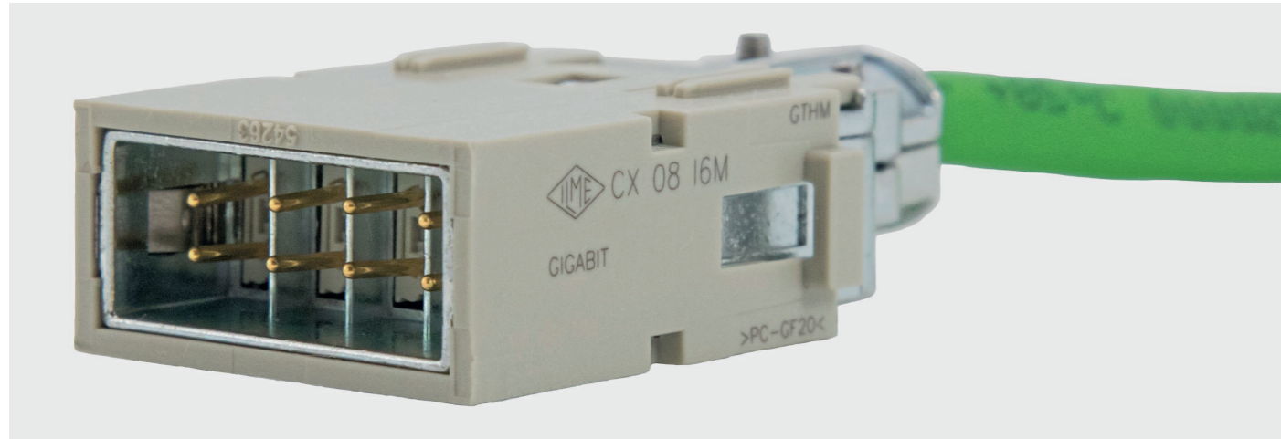
Bild 2: Das Steckgesicht des MIXO-Gigabit-Moduls CX 08 I6. Die spezielle Kontur des Moduls trennt die vier STP-Leiterpaare auch im Steckverbinder voneinander.
