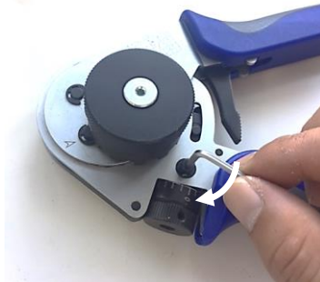
圧着深度調整スクリューの固定
