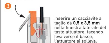
Inserire un cacciavite a taglio da 0,5 x 3,5 mm nella finestra laterale del tasto attuatore; facendo leva verso il basso, l'attuatore si solleva.
