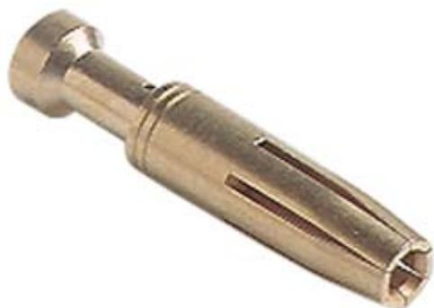
メス 圧着コンタクト, RC シリーズ, 16 A, 切削金メッキ, 導体断面積 4 mm<sup>2</sup>, AWG 12, HNM - 高嵌合回数 バージョン
