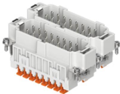
オス インサート, JSH S シリーズ, SQUICH® 工具不要バネ式結線, 16 極 + PE (17-32), 16 A 500 V 6 kV 3, サイズ "77.62"
