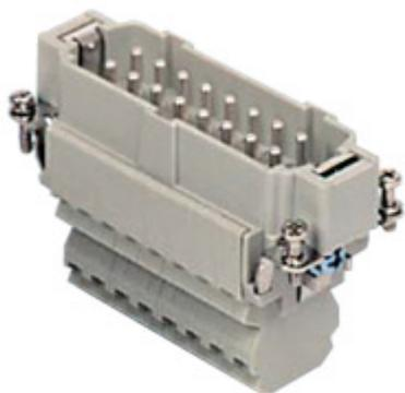
オス インサート, CSS シリーズ, デュアル バネ式結線, 16 極 + PE (17-32), 16 A 500 V 6 kV 3, サイズ "77.62"
