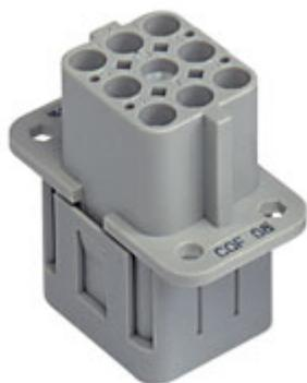
メス インサート, CQ シリーズ, 圧着式結線, 8 極 + PE, 16 A 500 V 6 kV 3, サイズ "32.13"
