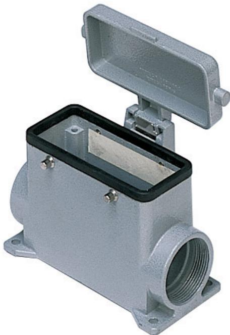
サーフェスマウントハウジング, 830V シリーズ, 4ペグ付, Pg29 x 2 ケーブルエントリー, サイズ "77.27", ハイコンストラクション, 金属カバー付
