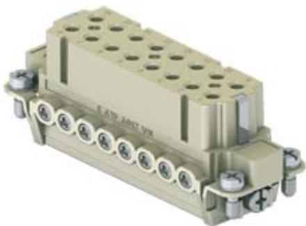
メス インサート, CDA シリーズ, ネジ式結線, 16 極 + PE (17-32), 16 A 250 V 4 kV 3, サイズ "66.40", プレート無し
