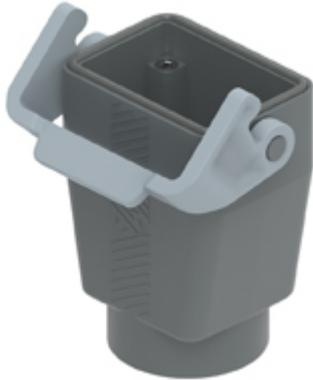
Custodia mobile, serie T-TYPE, con 1 leva, ingresso cavo M25 ingresso cavo verticale, grandezza "44.27", con ponticelli di terra integrati
