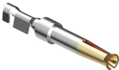
Contatto a crimpare femmina, serie SI, 5 A, stampato dorato, sezione conduttore 0,08 - 0,21 mm<sup>2</sup>, AWG 28 - 24, imballo in bobina, per 50 cicli di accoppiamento
