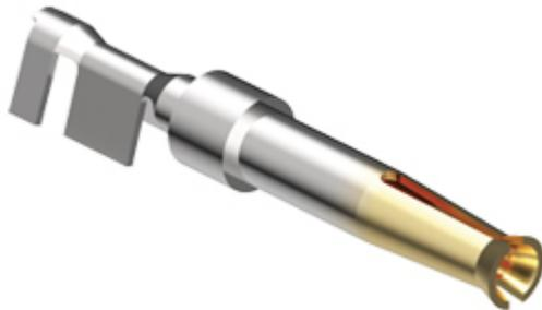
Contatto a crimpare femmina, serie SI, 5 A, stampato dorato, sezione conduttore 0,08 - 0,21 mm<sup>2</sup>, AWG 28 - 24, pezzi sciolti, per 250 cicli di accoppiamento
