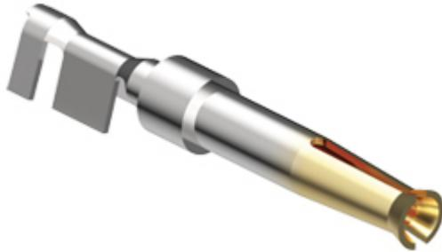
Contatto a crimpare femmina, serie SI, 5 A, stampato dorato, sezione conduttore 0,21 - 0,52 mm<sup>2</sup>, AWG 24 - 20, pezzi sciolti, per 500 cicli di accoppiamento
