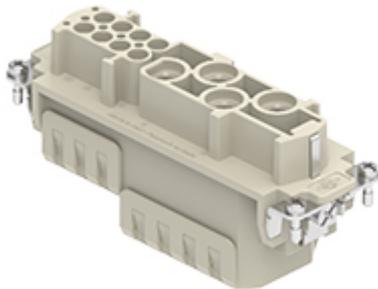
Frutto presa, serie RXC, connessione a crimpare, 4 + 8 poli + PE, 80 A 400 V 8 kV 3 / 16 A 230/400 V 6 kV 3, grandezza "104.27", versione HNM - High Number of Matings
