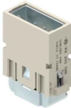
Frutto spina modulare, serie Mixo, connessione a crimpare, 20 poli, 1 modulo, 4 A 32 V 0,8 kV 3, schermato, con connessione di terra aggiuntiva, versione HNM
