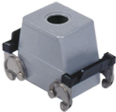
Custodia mobile, serie C-TYPE, con 2 leve, ingresso cavo verticale M32 senza adattatore, grandezza "66.40", alta, senza guarnizione
