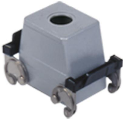
Custodia mobile, serie C-TYPE, con 2 leve, ingresso cavo verticale M25 senza adattatore, grandezza "66.40", alta, senza guarnizione
