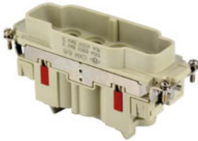
Frutto spina, serie CX, connessione a crimpare, 6 + 6 poli + PE, 100 A 690 V 8 kV 3 / 16 A 400 V 6 kV 3, grandezza "104.27"
