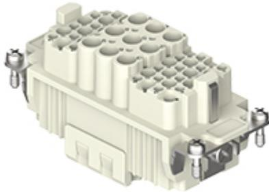
Frutto presa, serie CX, connessione a crimpare, 9 + 42 poli + PE, 40 A 690 V 8 kV 3 / 10 A 250 V 4 kV 3, grandezza "77.27"
