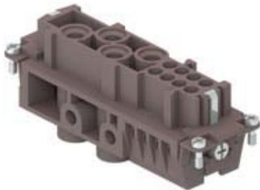
Frutto presa, serie CX RY, connessione con morsetto a vite, 4 + 8 poli + PE, 80 A 400 V 6 kV 3 / 16 A 230/400 V 4 kV 3, grandezza "104.27", per applicazioni fino a 180°C
