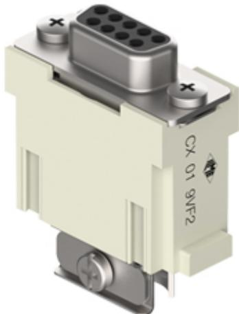
Frutto presa modulare, serie Mixo Data, D-SUB, 9 poli, 1 modulo, 5 A 50 V 0,8 kV 3, crimp, schermato, 2 ingressi cavo
