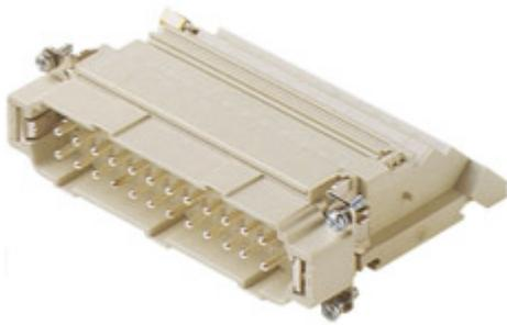
Frutto spina, serie CT, connessione con morsetto a vite, 24 poli + PE, 16 A 230/400 V 4 kV 2, grandezza "104.27", con morsettiera incorporata, montaggio lato destro
