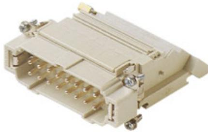
Frutto spina, serie CT, connessione con morsetto a vite, 16 poli + PE, 16 A 230/400 V 4 kV 2, grandezza "77.27", con morsettiera incorporata, montaggio lato sinistro
