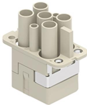
Frutto presa, serie CQ, connessione a crimpare, 4 + 2 poli + PE, 40 A 400/690 V 6 kV 3 / 10 A 250 V 4 kV 3, grandezza "32.13", con piastrina di terra integrata
