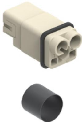
Frutto spina, serie CQ, connessione a crimpare, 2 poli + PE, 40 A 830 V 6 kV 3, grandezza "21.21", diametro cavo fino a 7,5 mm , con tubo isolante termoretraibile
