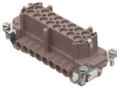
Frutto presa, serie CNE RY, connessione con morsetto a vite, 16 poli + PE, 16 A 500 V 6 kV 3, grandezza "77.27", per applicazioni fino a 180°C, con piastrina
