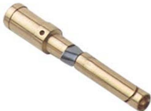
Contatto a crimpare femmina, serie CD, 10 A, tornito dorato, sezione conduttore 0,5 mm<sup>2</sup>, AWG 20, doratura ad alto spessore
