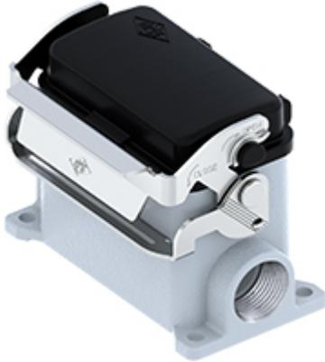
Sockelgehäuse, hoch, Gr.57.27, V-TYPE Alu, 1 Bügel Edelstahl, 1xM32 seitlich, Federdeckel
