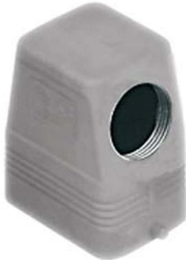
Tüllengehäuse, hoch, Gr.44.27, EMV Alu, 2 Bolzen, 1xM32 seitlich, ohne Stutzen
