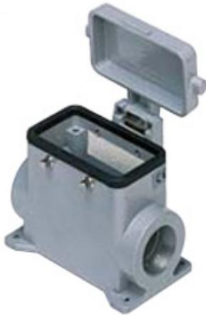
Sockelgehäuse, hoch, Gr.57.27, 830V Alu, 4 Bolzen, 2xPg 21 seitlich, Deckel Metall
